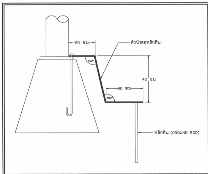
๙. เสาไฟฟ้าที่ติดตั้งบนสะพาน หรือกำแพงคอนกรีตให้ทำการเดินสายดินขนาดไม่น้อยกว่า ๑๖ ตร.มม. ลงมาเชื่อมต่อกับหลักดิน (Ground Rod) อย่างน้อย ๒ จุด ค่าความต้านทานระหว่างหลักดินกับดินต้องไม่เกินกว่า ๕ โอม หลักดิน ใช้ Copper or Copper Clad Steel ขนาดเส้นผ่าศูนย์กลาง ๑๖ มม. ยาว ๒.๔๐ ซม. การเชื่อมต่อระหว่างสายดินกับ หลักดินด้วยวิธี Exothermic Welding
