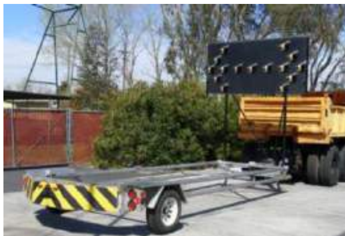
รูปที่ 1-8 ตัวอย่างรถกันชนพร้อมอุปกรณ์กันชนลดแรงกระแทก (Attenuator)
