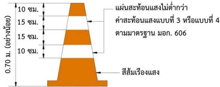
รูปที่ 3-1 อุปกรณ์จราจรประเภทกรวย
