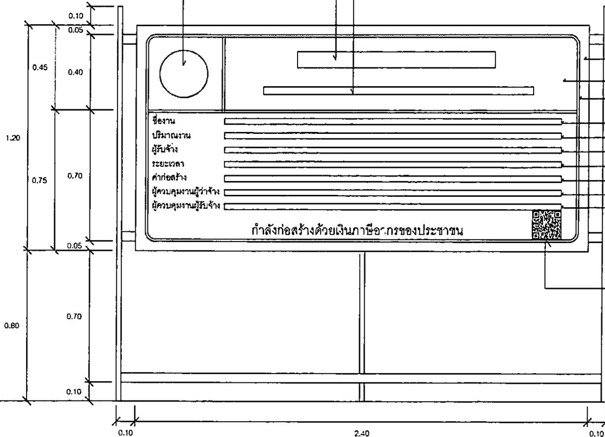
แผ่นไม้อัด 4 มม. โครงเคาะไม้ 2" x 4" หรือวัสดุอื่น
