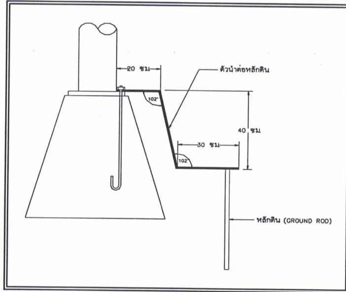
๙. เสไฟฟ้าที่ติดตั้งบนสะพาน หรือกำแพงคอนกรีตให้ทำการเดินสายดินขนาดไม่น้อยกว่า ๑๖ ตร.มม. ลงมาเชื่อมต่อกับหลักดิน (Ground Rod) อย่างน้อย ๒ จุด ค่าความต้านทานระหว่างหลักดินกับดินต้องไม่เกินกว่า ๕ โอห์ม หลักดิน ใช้ Copper or Copper Clad Steel ขนาดเส้นผ่าศูนย์กลาง ๑๖ มม. ยาว ๒๔๐ ซม. การเชื่อมต่อระหว่างสายดินกับ หลักดินด้วยวิธี Exothermic Welding
