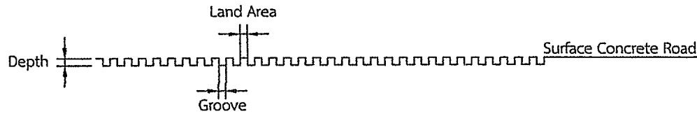
รูปแบบแนะนำ การทำการเซาะร่องด้วยวิธีการ Surface Grinding ผิวทางคอนกรีต
