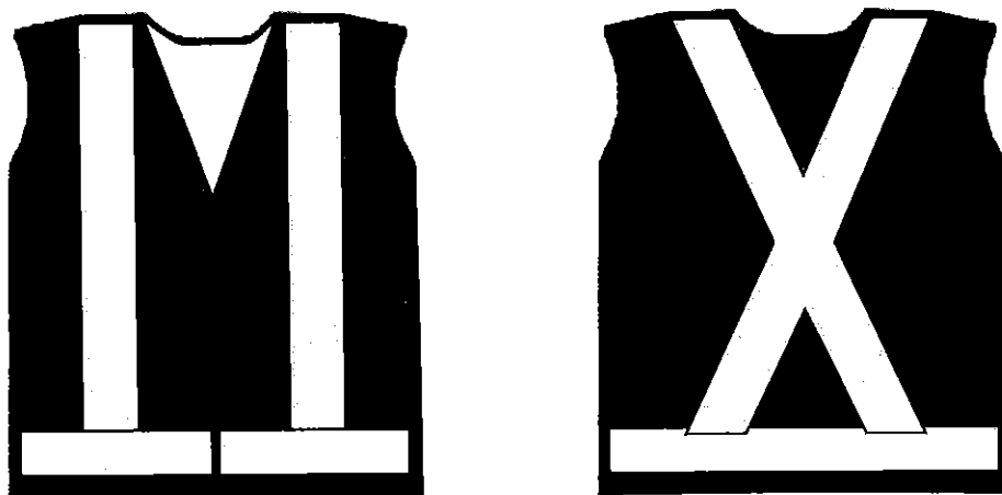
รูปที่ 1-4 ตัวอย่างเสื้อพร้อมสายคาดสะท้อนแสง สำหรับสวมในขณะปฏิบัติงาน
