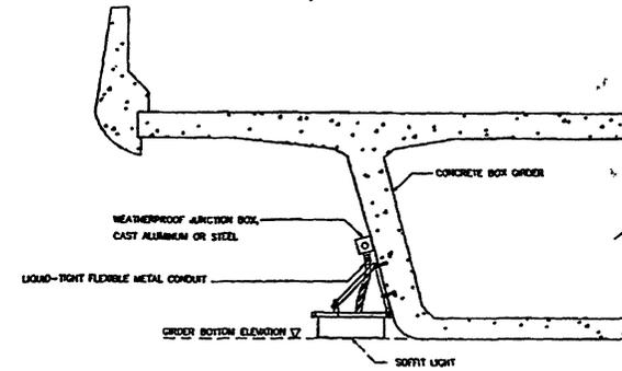
TYPE 2: SIDE OF CONCRETE BOX GIRDER
