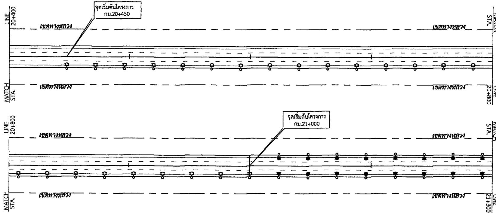
เสาสูง 9.00 M.(Mounting Height) Tapered steel Pole Single
