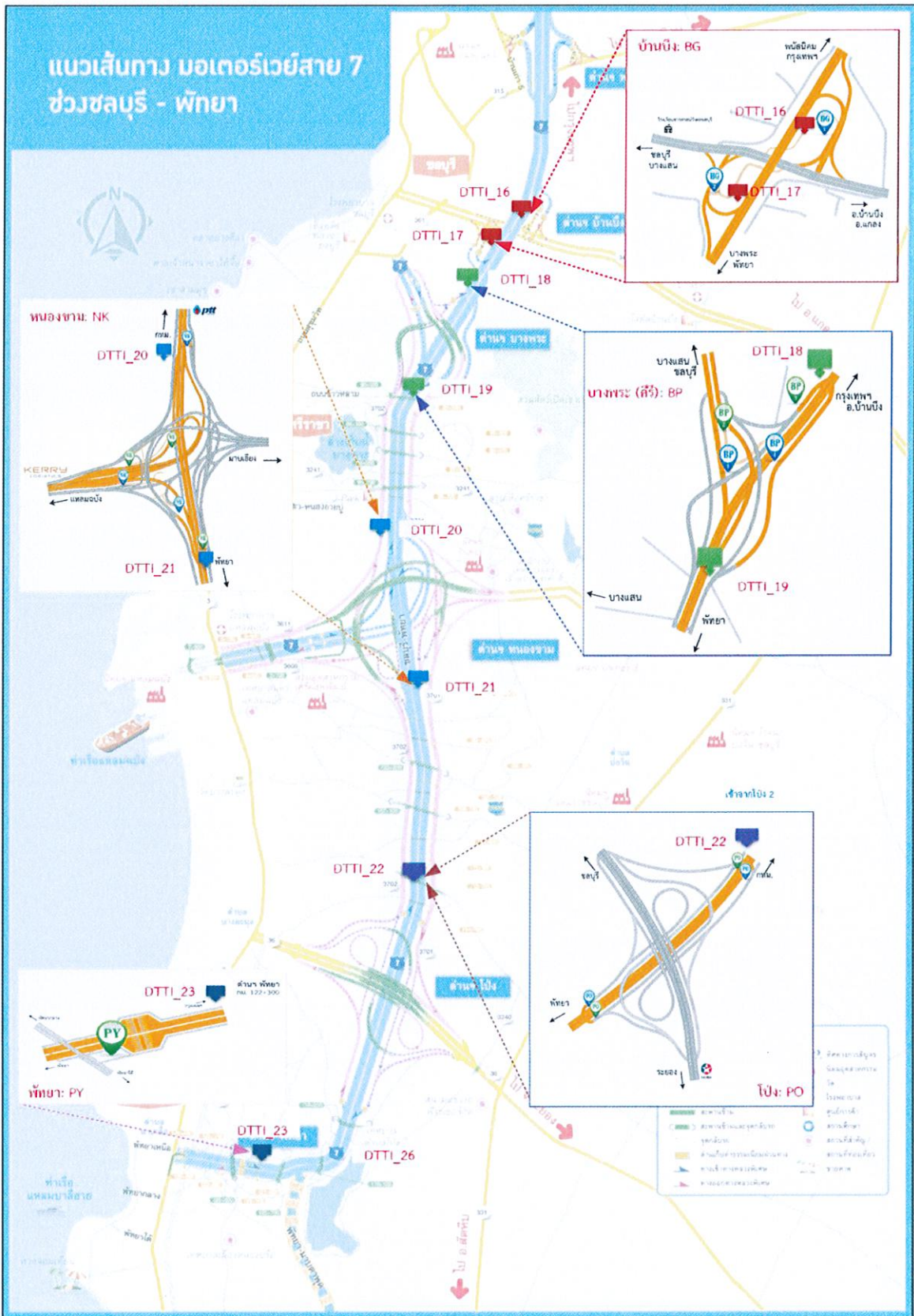
รูปที่ 2 ตำแหน่งติดตั้งระบบแสดงระยะเวลาเดินทางอัตโนมัติในช่วงด่านฯ บ้านบึง ถึง ด่านฯ พัทยา
