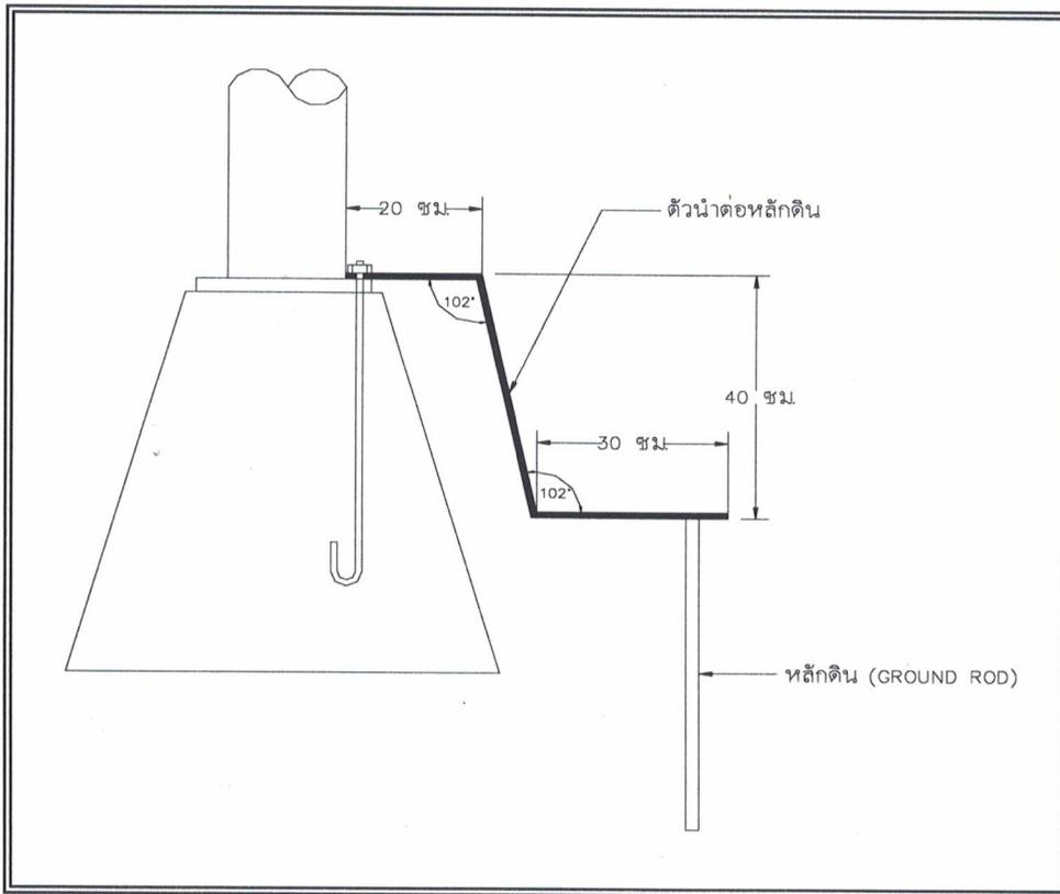
๙. เสายไฟฟ้าที่ติดตั้งบนสะพาน หรือกำแพงคอนกรีตให้ทำการเดินสายดินขนาดไม่น้อยกว่า ๑๖ ตร.มม. ลงมาเชื่อมต่อกับหลักดิน (Ground Rod) อย่างน้อย ๒ จุด ค่าความต้านทานระหว่างหลักดินกับดิน ต้องไม่เกินกว่า ๕ โอห์ม หลักดิน ใช้ Copper or Copper Clad Steel ขนาดเส้นผ่าศูนย์กลาง ๑๖ มม. ยาว ๒๔๐ ซม. การเชื่อมต่อระหว่างสายดินกับ หลักดินด้วยวิธี Exothermic Welding
