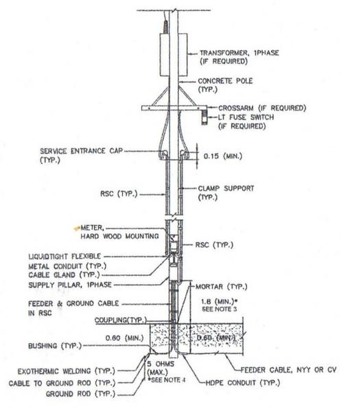
กรณีติดตั้ง SUPPLY PILLAR แขนงที่เสาด้านติดตั้งมิเตอร์ไฟฟ้า
