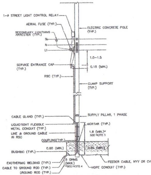
แบบที่ 1: การติดตั้งอุปกรณ์บนเสาไฟฟ้าคอนกรีต
