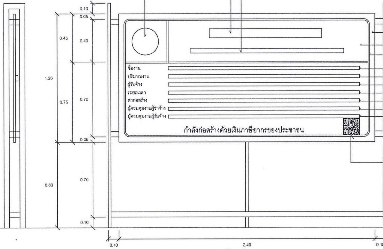
แผ่นไม้อัด 4 มม. โครงคร่าวไม้ 2" x 4" หรือวัสดุอื่นที่มีความคงทน เหมาะสมกับสภาพพื้นที่ก่อสร้าง
