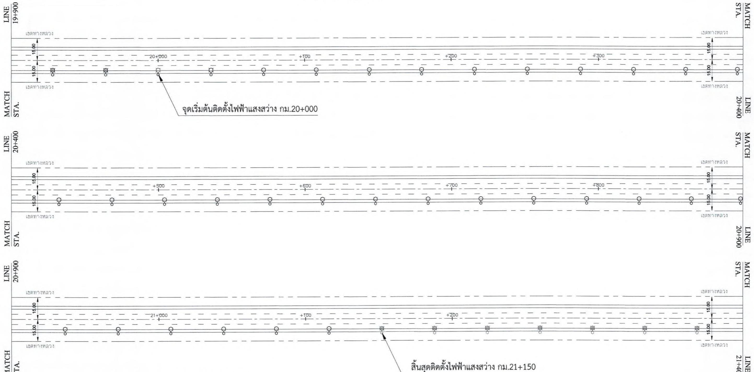
เสาสูง 9.00 M.(Mounting Height) Tapered steel Pole Single
